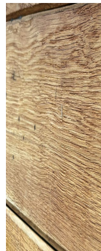
Im Längsschnitt sind in den Bohlen und Brettern die kleinen runden Bohrlöcher sichtbar, die dem Holz die antike Note geben.
